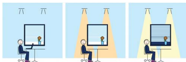
Obr.5: Mód 1 – regulace na základě denní osvětlenosti
