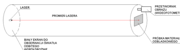
Rys.2. Urządzenie do badania rozkładu powierzchniowego współczynnika odbłasku.
