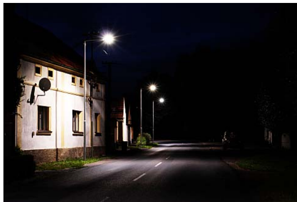
Obr. 5 – Osvětlovací soustava LED – Míra rušivého světla na oknech zcela jistě přesahuje přípustné hodnoty. Nerovnoměrnost osvětlení na komunikaci je daleko za přípustnými mezemi.
