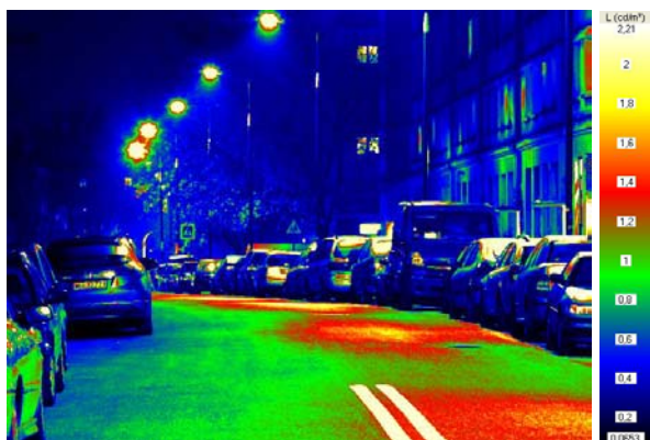
Rys. 5. Pomiar rozkładu luminancji ulicy w rejonie odcinka pomiarowego matrycowym miernikiem luminancji - położenie lewe obserwatora
