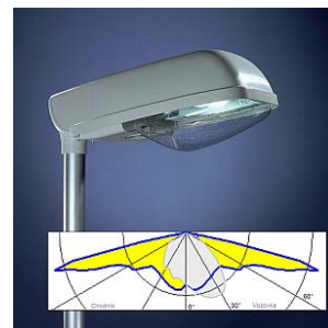
Obr. 3 – Charakteristický průběh svítivosti svítidla pro osvětlování komunikací. Značně odlišná od svítidla na obr. 2; pro úhel 75° je svítivost dvaapůlkrát vyšší než směrem k zemi. Z obrázku je zřejmé, že směrem k vozovce (doprava) je vyzářováno více světla než k chodníku (šedě vyplněná křivka).
